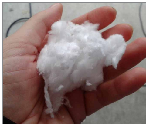
A Supafil gyapotdarabok hidrofóbizáltak, a néhány cm hosszú szálak kis vattapamacsoként egymáshoz tapadnak.
